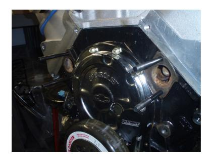
INSTALL THE GASKETS WITH SEALER AND SLIDE THE WATER PUMP SPACERS OVER THE STUDS, FOLLOWED BY THE WATER PUMP HOUSING.
