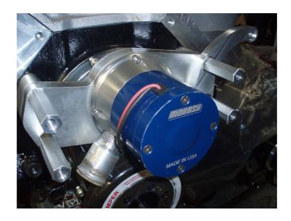
SECURE THE PUMP HOUSING TO THE MOTOR USING THE THREADED HEX STANDOFFS. THE LONGER ONES GO ON THE PASSENGER'S SIDE.
