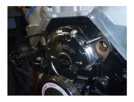
INSTALL THE GASKETS WITH SEALER AND SLIDE THE WATER PUMP SPACERS OVER THE STUDS, FOLLOWED BY THE WATER PUMP HOUSING.
