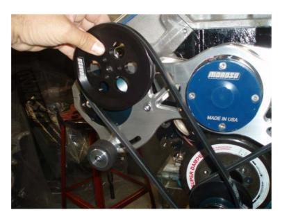
FASTEN THE VACUUM PUMP PULLEY TO THE PUMP
