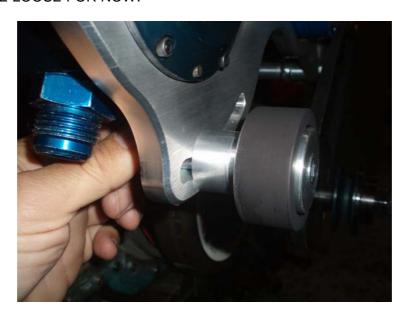
PLACE THE BELT\* OVER THE VACUUM PUMP PULLEY (MOROSO# 64885) AND ENGAGE THE 2  $\frac{1}{2}$ " CRANK PULLEY (MOROSO# 23250) AS SEEN IN THE PHOTO BELOW
