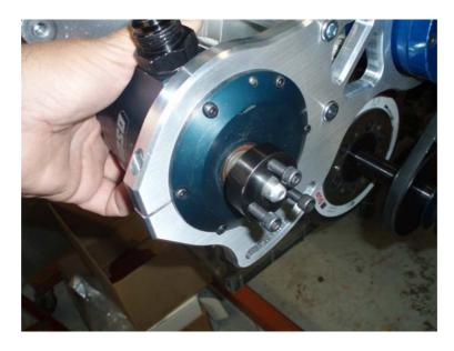
THE PUMP SHOULD FIT FLUSH WITH THE FACE OF THE BRACKET (SEE BELOW)
