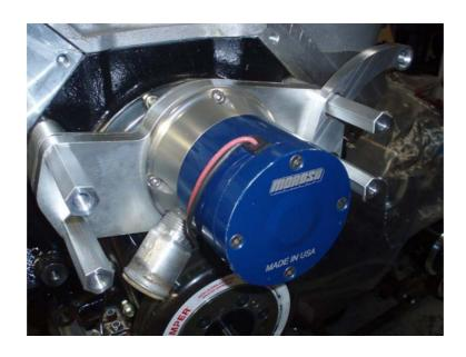
SECURE THE PUMP HOUSING TO THE MOTOR USING THE THREADED HEX STANDOFFS. THE LONGER ONES GO ON THE PASSENGER'S SIDE.
